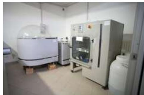
Figure: apparecchiatura per la resistenza alle atmosfere umide.
