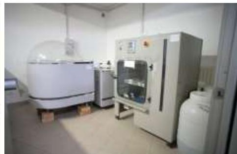
Figure: apparecchiatura per la resistenza alla nebbia salino-acetica.
