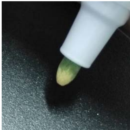
Figura 5-6: Assorbimento dell'inchiostro sulla punta del Gi-PEN
