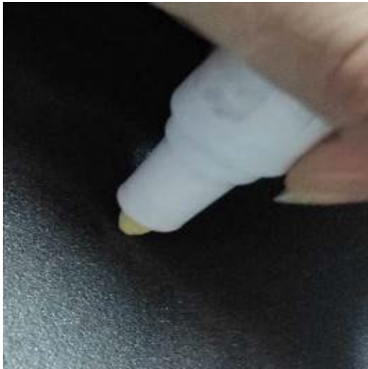
Figura 3-4: Assorbimento dell'inchiostro sulla punta del Gi-PEN
