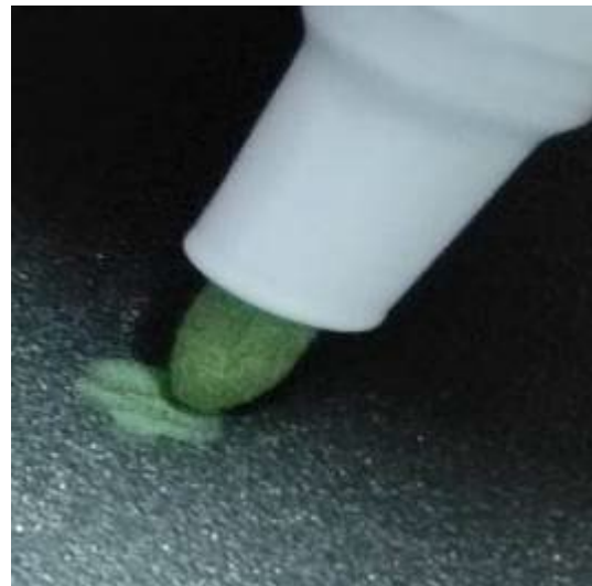
Figura 5-6: Assorbimento dell'inchiostro sulla punta del Gi-PEN
